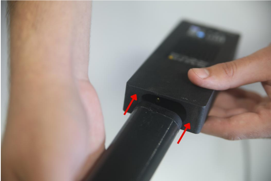
Figure 36 – Inserting AV Battery into Charger
